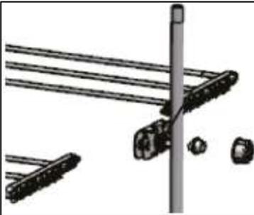
AUFHÄNGER (1): Mittlere Verbindungsstücke (B) einzeln auf das vertikale Basisrohr (H) schieben und mit den Befestigungen (I) leicht festmachen.
