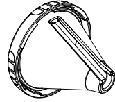
Élément de coupe spirale avec lame lisse
