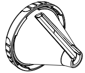
Spiraleinsatz mit glatter Klinge
